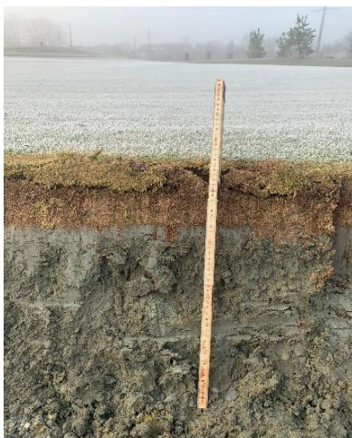
Vorgreen 1 vorher, 10 cm A-Boden auf Lehm, nachher 40 cm Rasentragschicht mit Drainage
